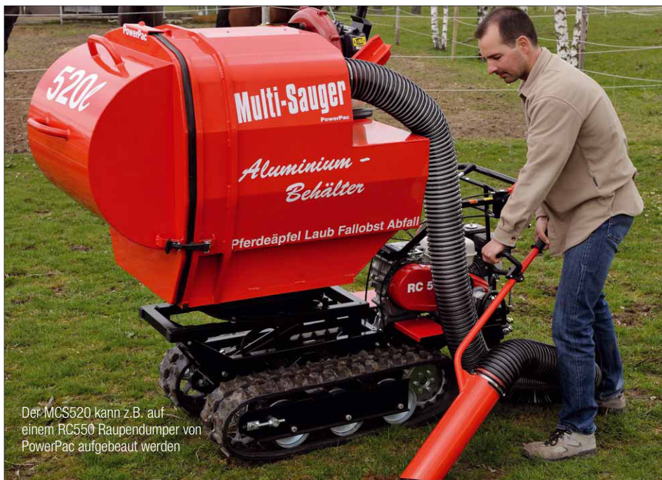
Als „Saugereinheit“ dient ein Tückettrage-Gebläse von Husqvarna, das an das an den Behälter montiert ist
